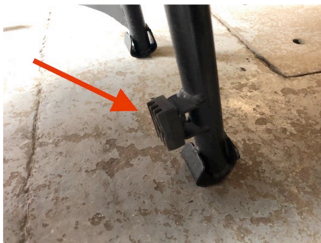
7) REMOVE STAND STOP RUBBER
